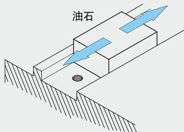
2 将直线导轨平稳的放在床台上，并让导轨侧边基准面靠上床台装配面。
