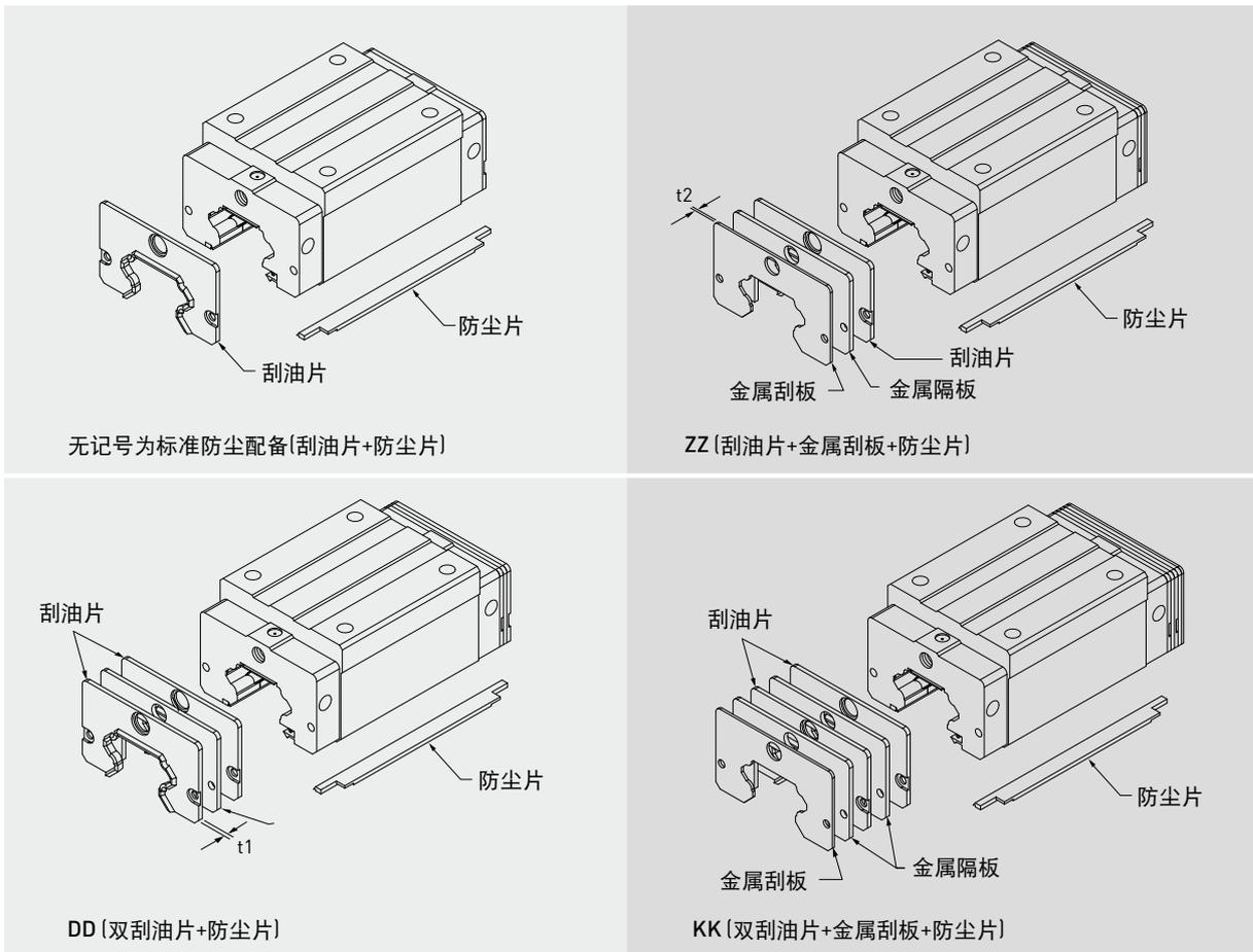
注：HG20/HG25/HG65无金属隔板构型
