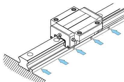
5 使用扭力扳手，以特定扭力按顺序锁紧装配螺丝，将导轨底部基准面逼紧床台底部装配面。
