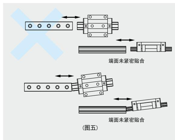
6. 安装直线导轨时，请勿将非互换型导轨之滑块任意对调使用，以免影响精度。
