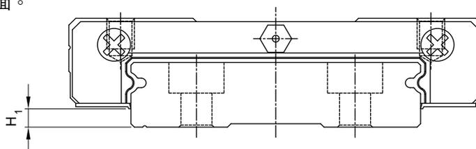
表格2-4-7 附防尘片滑块之安装面间隙H<sub>1</sub>
