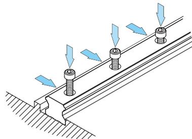
4 使用侧向固定螺钉，按顺序将导轨侧边基准面逼紧床台侧边装配面，以确定导轨位置。
