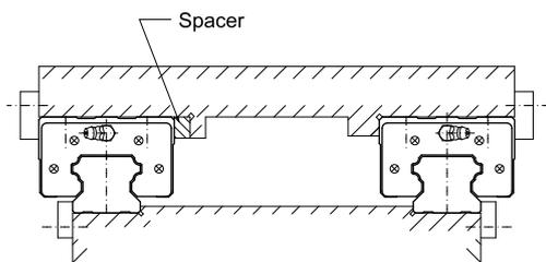
HGW型滑块装配螺栓取不同方向配置
