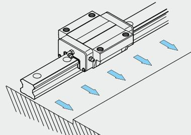
3 试锁装配螺丝以确认螺栓孔是否吻合，并将导轨底部基准面大概固定于床台底部装配面。
